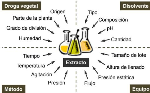
FIGURA 6. Factores que influyen en el proceso de extracción con disolventes.
